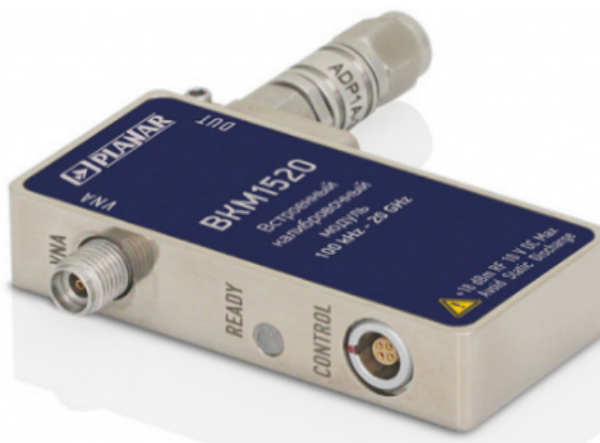
Рисунок 12 – Встроенный автоматический калибровочный модуль
